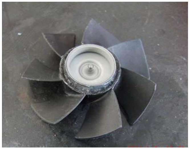
八、風扇葉片：電腦用電源供應器散熱風扇
