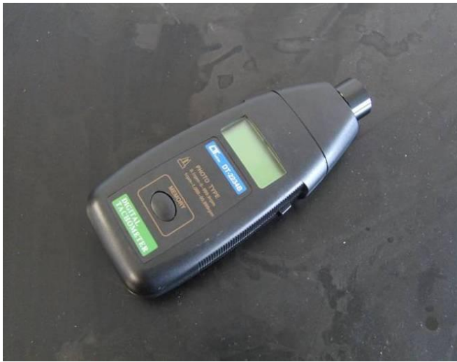
七、電子轉速計：測量馬達轉速及製波器頻率
