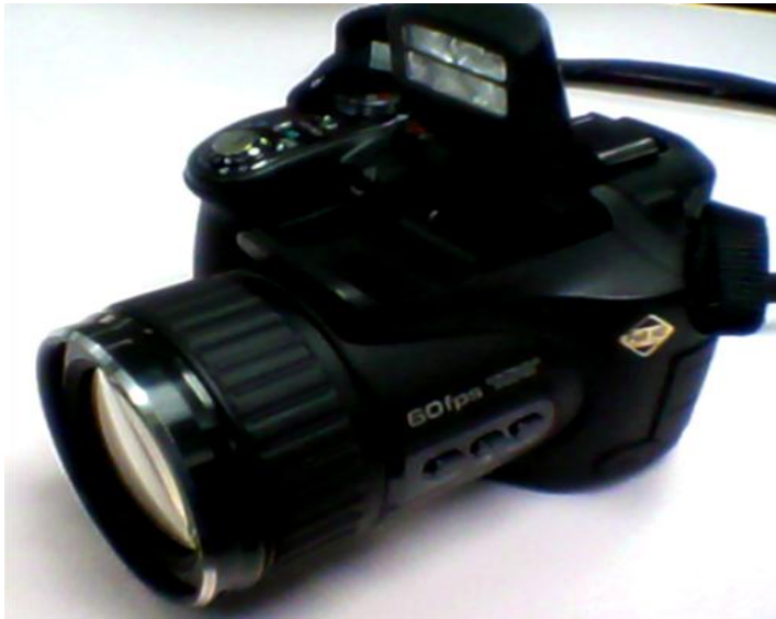
三、快速照相機：用來拍攝產生的波形後傳到電腦進行分析
