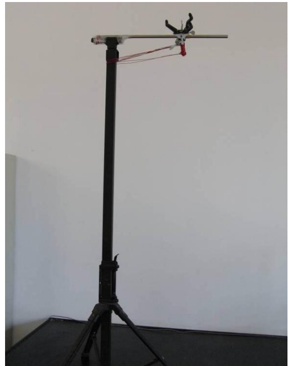
四、相機腳架：市售相機腳架不便於固定相機垂直向下拍攝，故自行用望遠鏡腳架及鐵夾組合出適用的固定裝置
