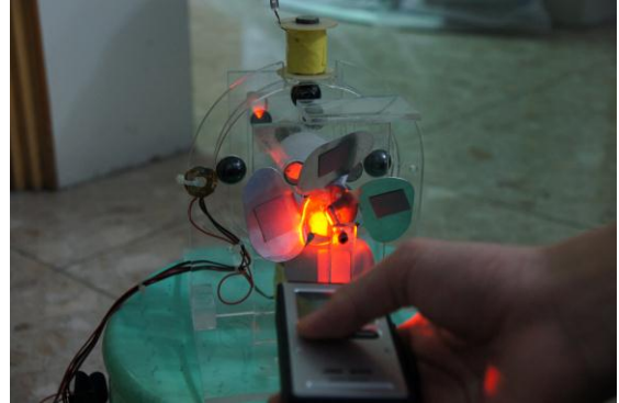
圖 26、轉子加裝 4 極磁鐵，測量轉速
