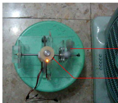
圖 25、三代機風力發電測試圖-使 LED 燈發亮
