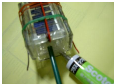
圖 2b、太陽能板框架固定
