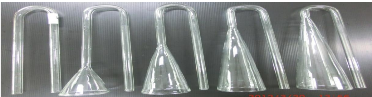
圖 41：玻璃管下方不同高度的漏斗
