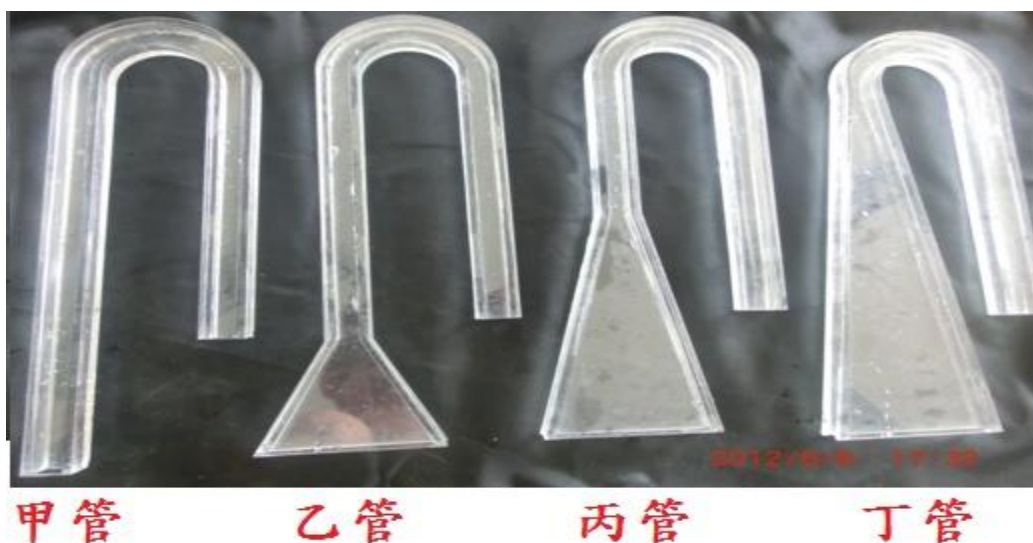
圖 36：下方為不同高度的漏斗型壓克力管
