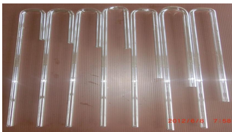
圖 27：不同外管長度的玻璃虹吸管共 7 支
