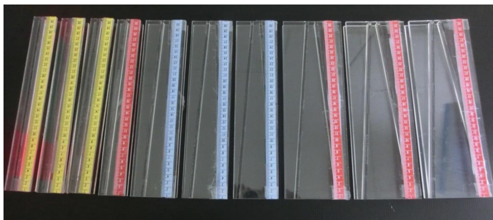
圖 28：10 支梯形壓克力管口下端開口寬度的實際儀器
