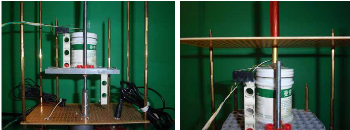
模擬貢香燃燒時貢香會隨時間的增加而減短的螺桿升降機構與升降的極限保護
