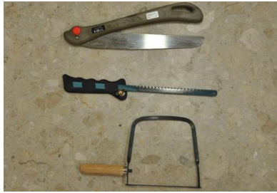
上：手工木鋸/中：手工鋼鋸/下：線鋸
