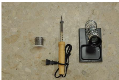
左：焊錫/ 中：電烙鐵/ 右：烙鐵架
