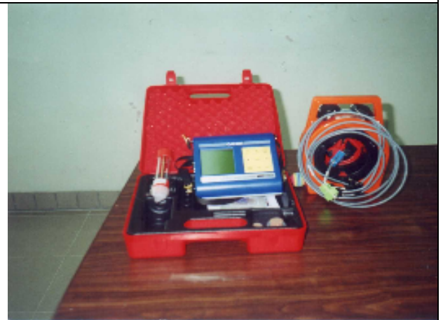
鋼筋腐蝕量測儀
