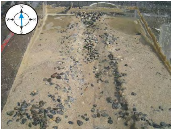
(圖 24，第一次水流事件所造成的河道)
