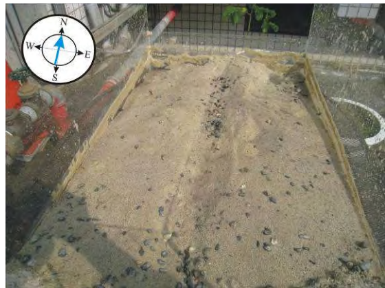
(圖 27，第四次水流事件所造成的河道)
