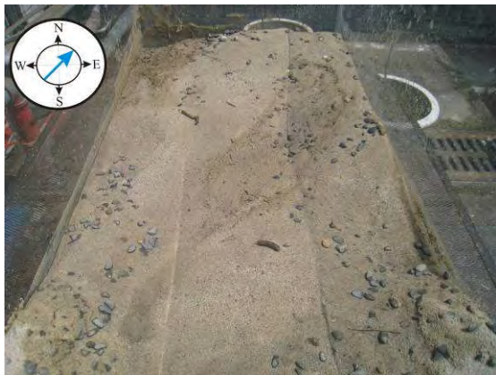
(圖 28，第五次水流事件所造成的河道)
