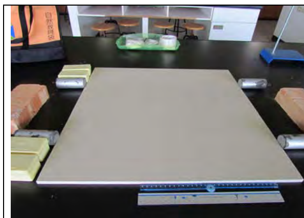
使用拋光石英地磚來降低摩擦力
