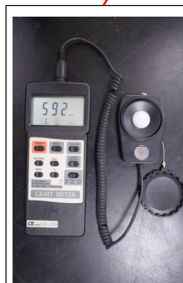
圖十六、 光度計 ： 監控紙箱中 光度，確認 箱中完全沒 有光進入。
