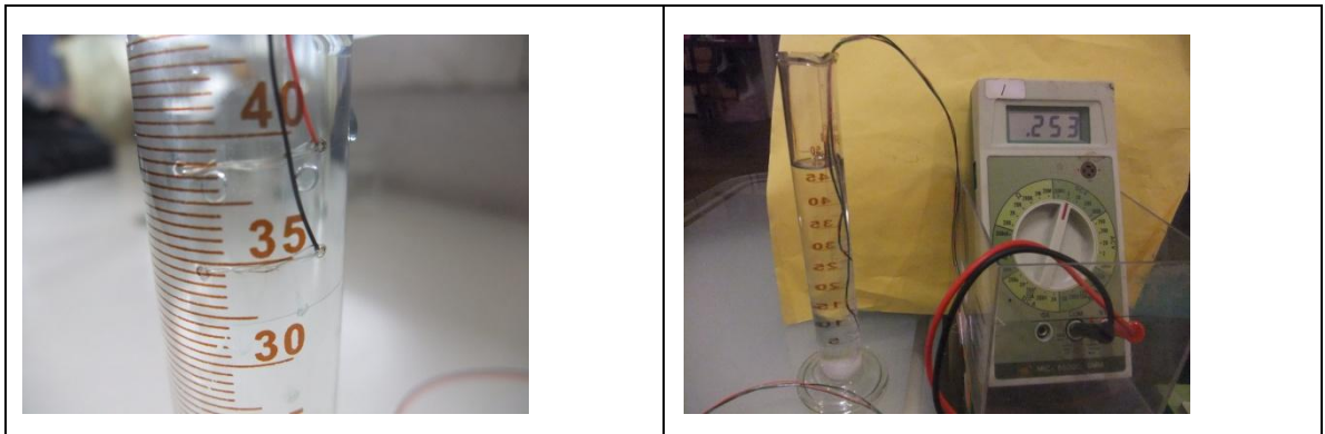
圖1 微型電極，測量液/液界面層的擴散電位
