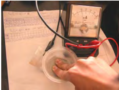
使用時以手部加壓以減少電阻 電流電壓可以達到 100mA 左右
