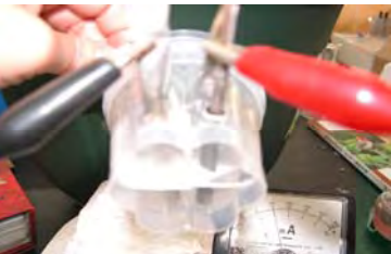
廢鋁鐵第二代電池中可看見負極處生成較多的氣泡 而正極處生成較少的氣泡
