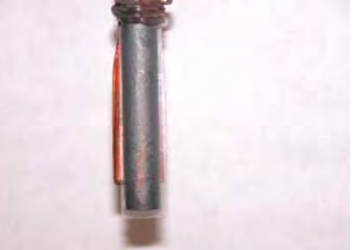
電鍍後的碳棒上吸附還原後的銅
