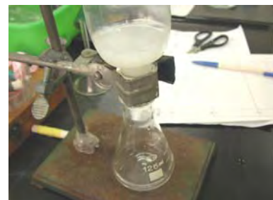
改用錐形瓶使液滴沿壁面流入瓶內
