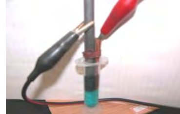
以注射針筒電鍍槽電鍍銅(正極銅箔、負極碳棒)
