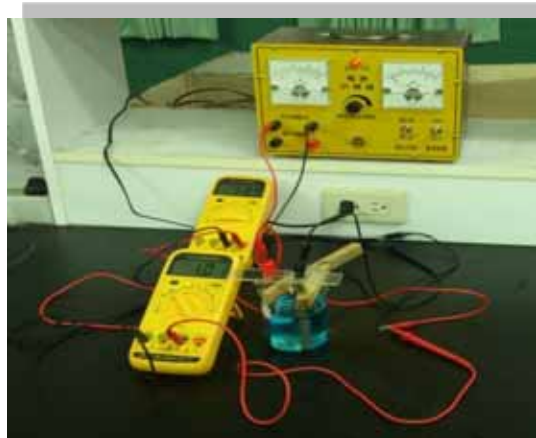
溶液隨電壓的導電性測量裝置
