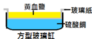
圖(五) 製備亞鐵氰化銅玻璃紙裝置
