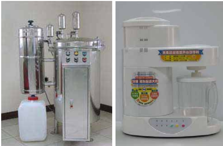
圖二、製酒與蒸餾乙醇機器
