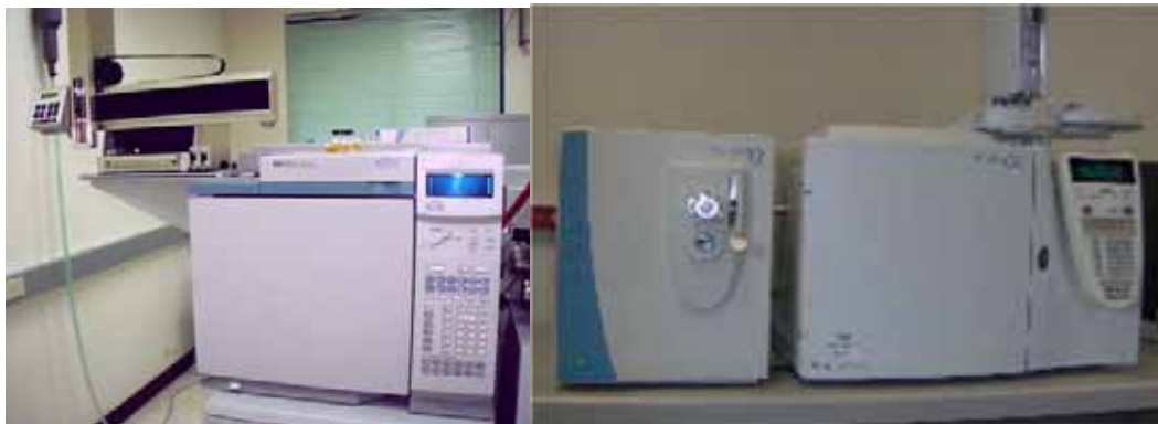
圖九. 多環芳香烴(PAHs)測試測定儀器(高雄醫學大學研究資源整合開發中心)
