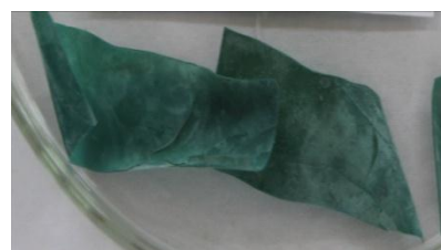
圖四十三 GA2 0.2g \text{CuSO}_4 0.04M 90min 30ml pH7
