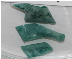
圖四十二 GA1 0.2g \text{CuSO}_4 0.04M 90min 30ml pH7
