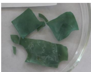
圖四十一 GA0 0.2g \text{CuSO}_4 0.04M 90min 30ml pH7
