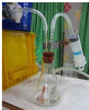
圖 20 以導線連接鋅片與銅片，並加入鹽酸，收集鋅片與銅片所產生的氣體。
