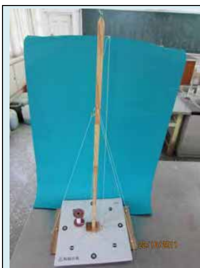
圖 4 太陽仰角與方位角測量裝置圖
