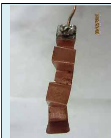
圖 14 電解後弓形銅片 1 上面銅析出情形
