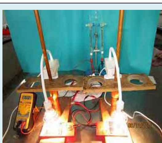
圖 10 鹵素燈下 5cm，兩個太陽能板 (SM5055、SM5055)串聯為電源電解水
