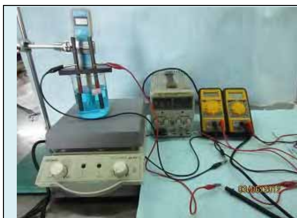
圖 12 以 石墨棒 為電極，直流電源供應器為電源，電解 0.1\text{M CuSO}_4(\text{aq}) 裝置圖
