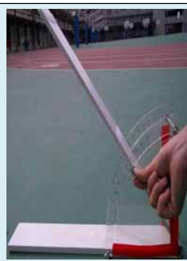
圖 6 調整太陽能板支架側面的螺絲，使角度等於太陽仰角的餘角
