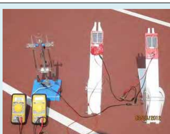
圖 11 太陽下以兩個 SM5055 太陽能板串聯為電源、電池回收碳棒為電極電解水的實驗裝置
