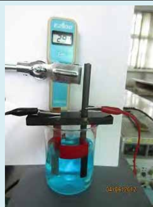
圖 13 以 直銅片 為電極，直流電源供應器為電源，電解 0.1\text{M CuSO}_4(\text{aq}) 裝置圖
