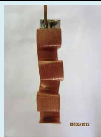
圖 52：弓形銅片上銅原子析出情形
