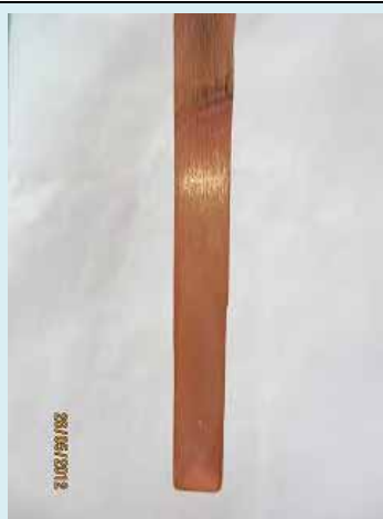
圖 51：電解後：銅片上銅析出的情形。
