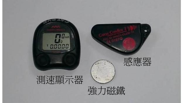
圖 12 測速顯示器、感應器、強力磁鐵
