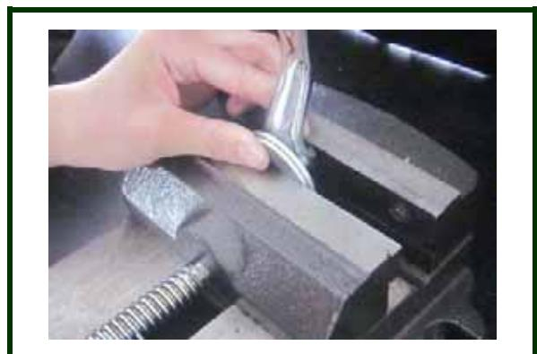
圖 7：利用墊片，使萬力夾前後拉放固定在一個範圍內
