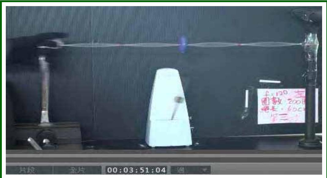
圖 35：在適當條件下，繩子兩端竟然都產生 1 個完整的共振波。
