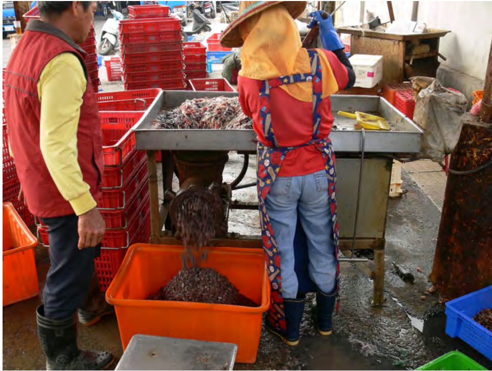
照片 5. 打碎之下雜魚經機器製成魚漿之過程
