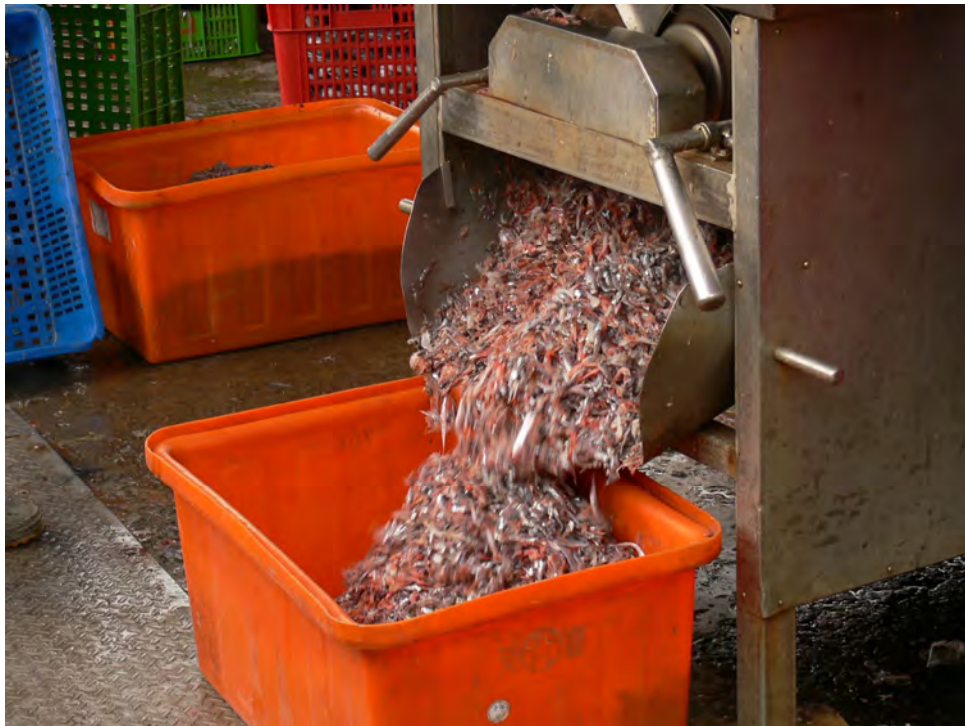
照片 4. 東港小型之混獲魚獲於岸邊之加工廠先打成碎粒之過程
