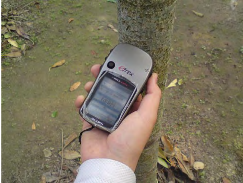
圖九 GPS 手持儀(eTrex Vista Hcx)於測定座標索引值(經緯度系統)表現最佳
