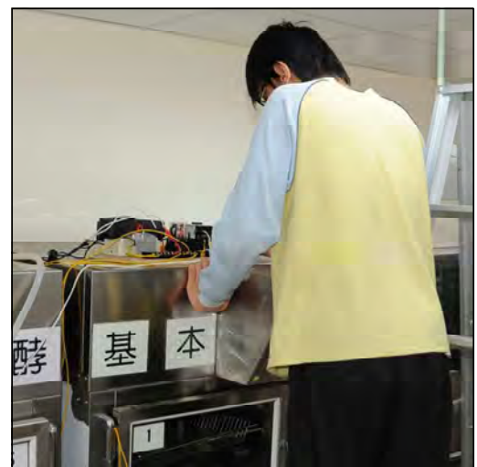
圖 18 超音波霧化型濕度控制系統安裝在第三代發酵箱
