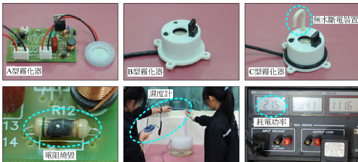
圖 10 超音波霧化器之測試
