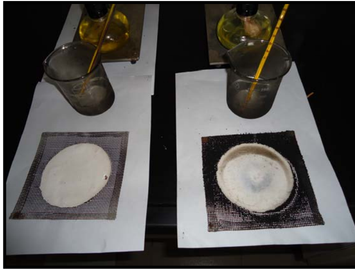
圖十 燒後陶瓷纖維網 (左 自製生質柴油/右 加油站柴油)
