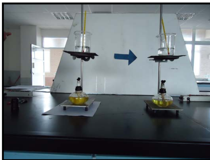
圖八 溫度測定 (左 自製生質柴油/右 加油站柴油)
