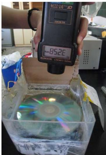
圖八、測試自製旋轉塗佈機的轉速
