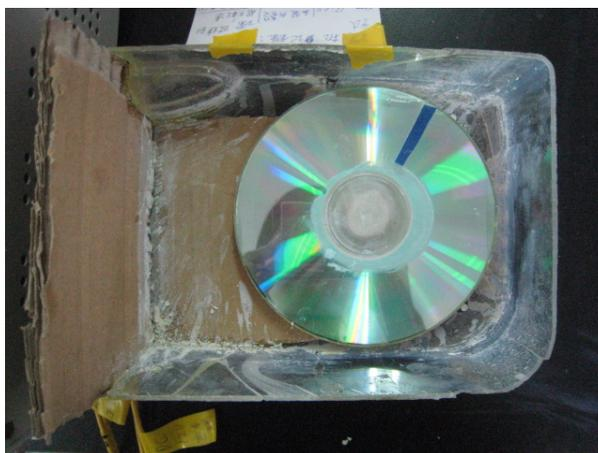
圖十八、自製旋轉塗佈機，以硬碟、保特瓶蓋、眼藥水瓶蓋、光碟及電源供應器自製旋轉塗佈機。
