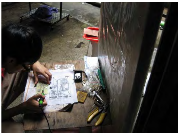
圖三十九、手工焊接
