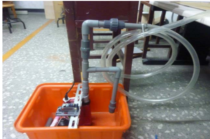
圖八 抽水機加壓模擬供水水塔
