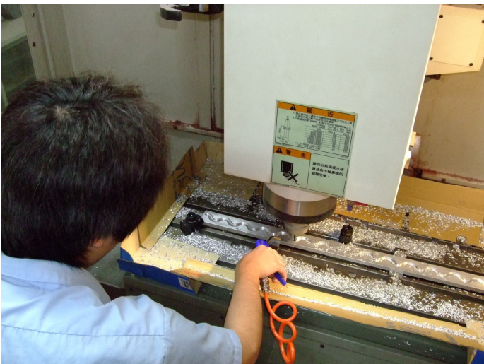
圖 38.CNC 銑床加工 S 凸輪
