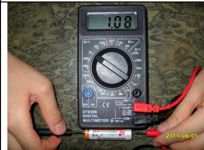
13. No1 電池，充電 40 分鐘電壓測量(1.08v)
