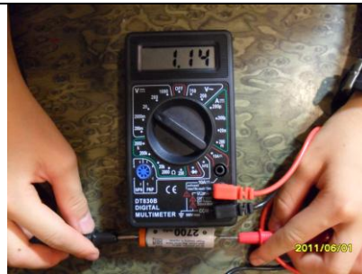
14. No2 電池，充電 40 分鐘電壓測量(1.14v)
