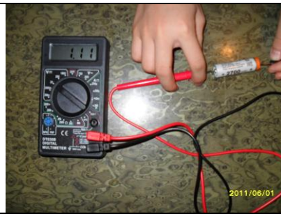
11. No2 電池，充電 30 分鐘電壓測量(1.11v)
