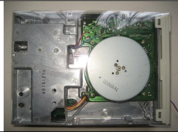
2. 磁碟機加裝防水層
