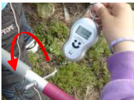
照片 4-10 用電子吊秤測量施力大小
