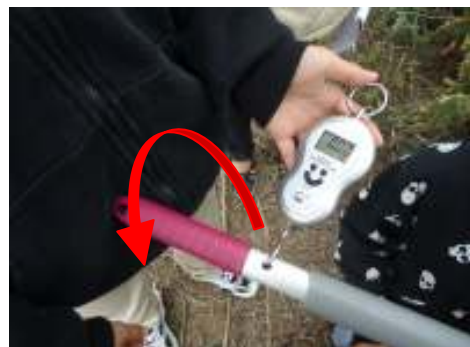
照片 4-11 修正電子吊秤測量施力大小方式
