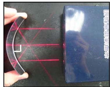
鏡子越凹聚集點越靠近鏡子
