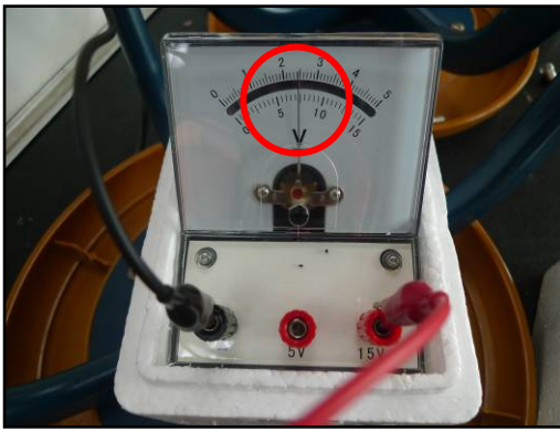
太陽能板可以運作，發電電壓 7.5V
