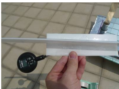
把電子溫度計黏在塑膠支架上。
