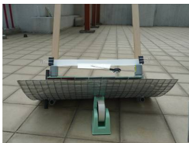
利用黑色吸管的輔助，把凹面反光鏡對準太陽。
