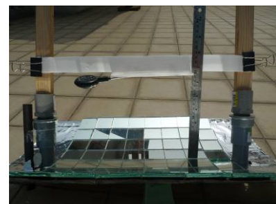
測量不同高度 1 分鐘內的最高溫。
