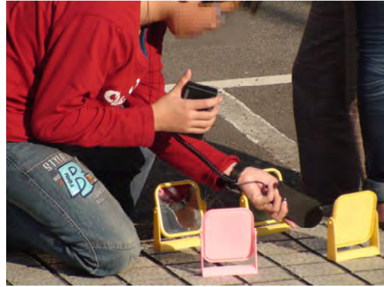
測量投射在「反射鏡」陽光的照度
