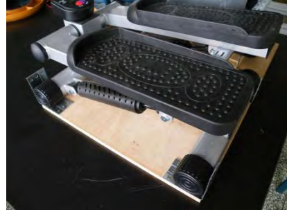
木板鎖上 L 鐵做為固定踏步機的裝置
