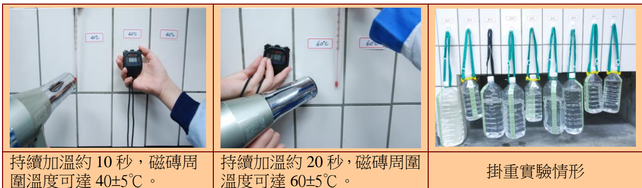
圖 13：磁磚牆溫度對掛鉤載重影響測試
