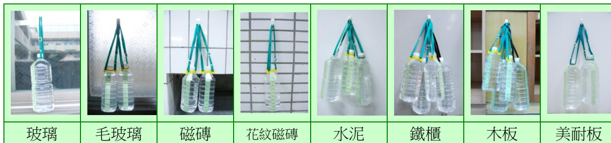
圖 6：相同掛鉤在不同材質的牆面負載重量圖
