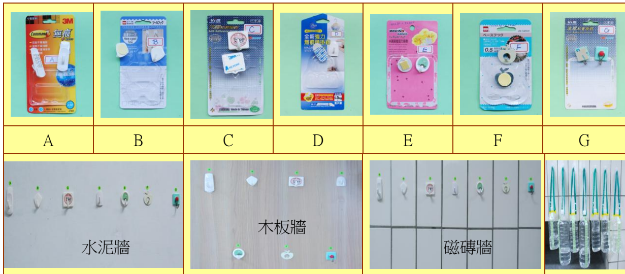
圖 7：不同廠牌掛鉤標示與實際負載重量測試
