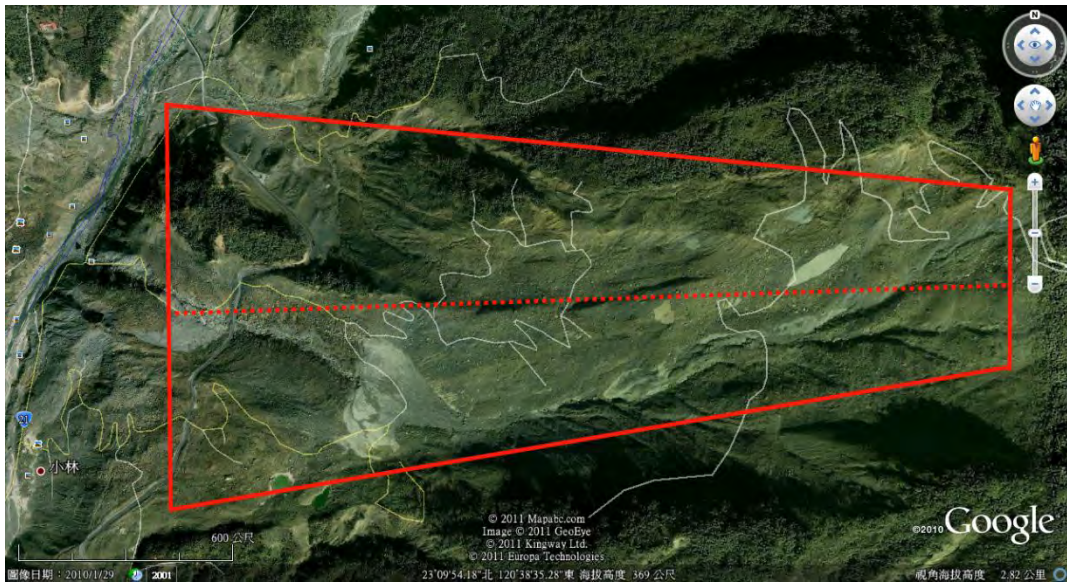
圖三 獻肚山衛星空照圖近似梯形可算出崩塌面積
