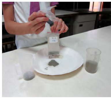
5.將鐵砂放入夾鏈袋內，不含鐵 砂的沙子放入左邊小量杯內
