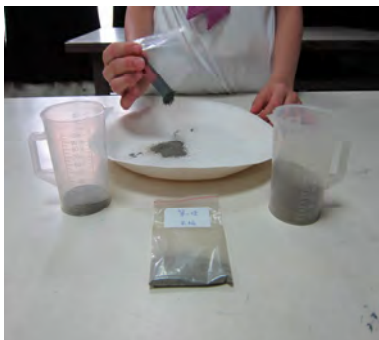
4.將少量的沙子放入紙盤， 使用磁鐵篩選鐵砂
