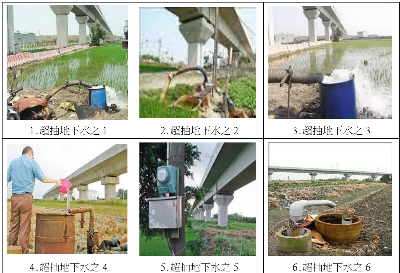
圖 4-10：高鐵沿線超抽地下水導致地層下陷日益嚴重（資料來源：經濟部水利署）
