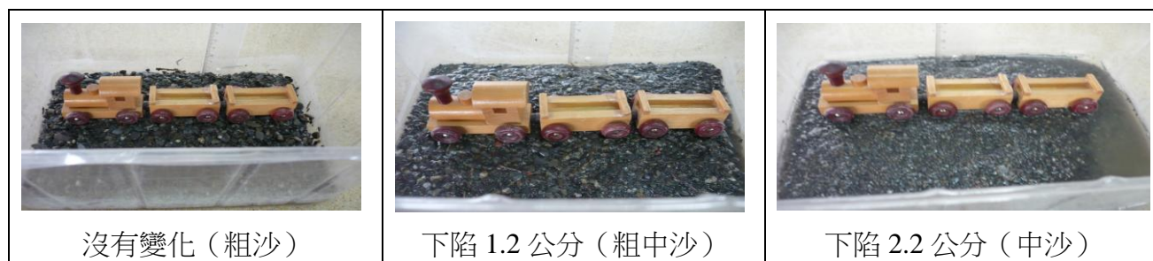
圖 4-3：模型列車震盪搖晃下陷前位置
