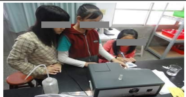
『分光光度計』測量 氮、磷、鉀 的吸收波長
