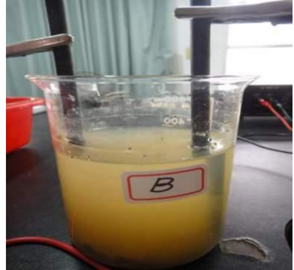
上平林 B 果園土壤加水後，測電阻情形。
