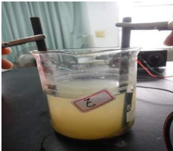
下平林 E 果園土壤加水後，測電阻情形。
