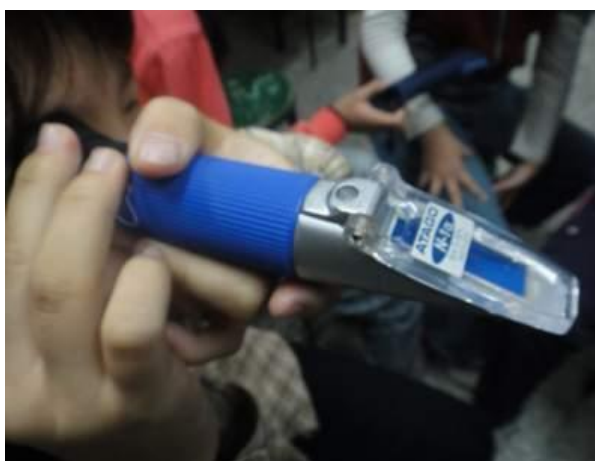
蓋上『甜度計』的蓋子後進行觀測。
