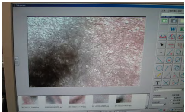
圖十五、使用顯微鏡分析色素分佈
