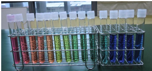
圖 44：左至右 pH=0~14 15 瓶標準溶液的顏色變化
