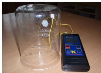
\*第一受測點和第五受測點高度為 13 公分（從杯底至黏著點中央計算），分別設置在相互面對的位置。
