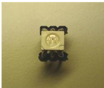
圖(七) 國內某 LED 大廠所生產之三合一封裝的 LED
