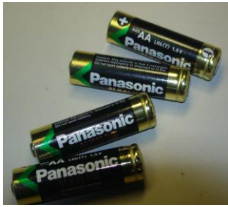
圖(八) 三號電池
