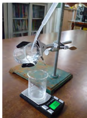
圖 2-3：用滴管滴水注入斜置的燒杯中。
