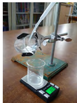
圖 2-4：滴水至水開始漏到秤上燒杯內為止。
