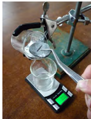
圖 2-6：用鑷子將要測量的石頭放入斜置的燒杯中。
