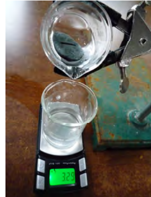
圖 2-7：待燒杯中的水不再滴落時，讀取電子秤上數字。
