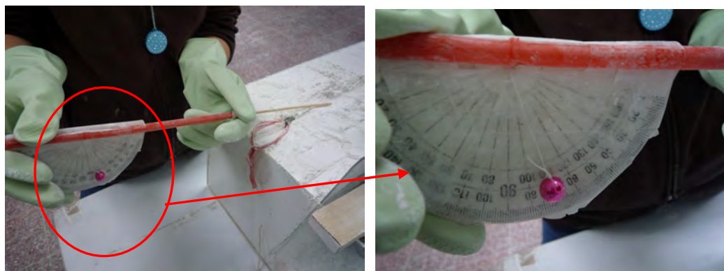
圖 9-4：利用自製儀器「角度測量儀」丈量粉凹洞入射角及射出角。
