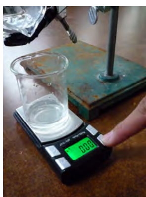
圖 2-5：待燒杯中的水不再滴落時，將電子秤歸零。
