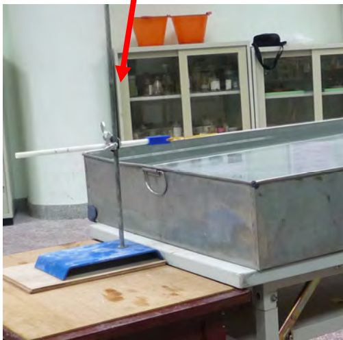
圖 3-8：彈性線材固定在支架上。
