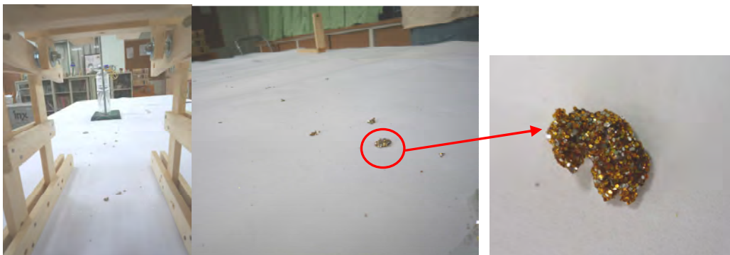
圖 4-6：第二種線材組合(橡皮筋+釣線)的金銀蔥粉噴灑的軌跡。
