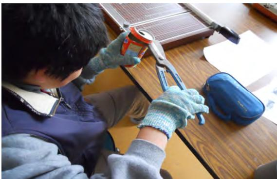
圖4-6 使用巨型鐵剪刀將鐵罐外殼剪開
