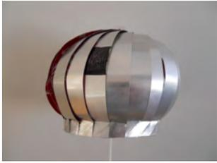
圖4-38葉片斜角0度
