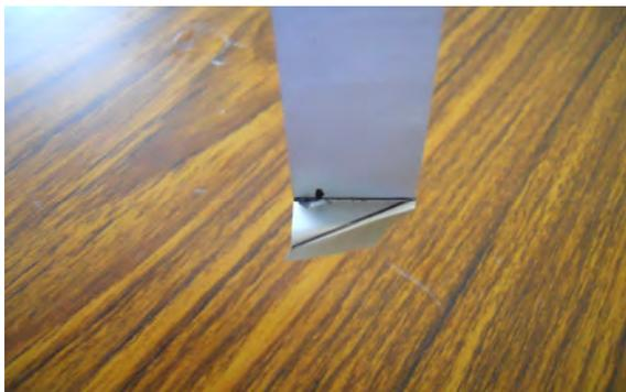
圖4-24 彎曲指定斜角的鋁製葉片
