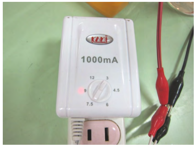
圖7 將可調式變壓器調整至3V電壓，轉換教室插座內提供的交流電源為直流電。
