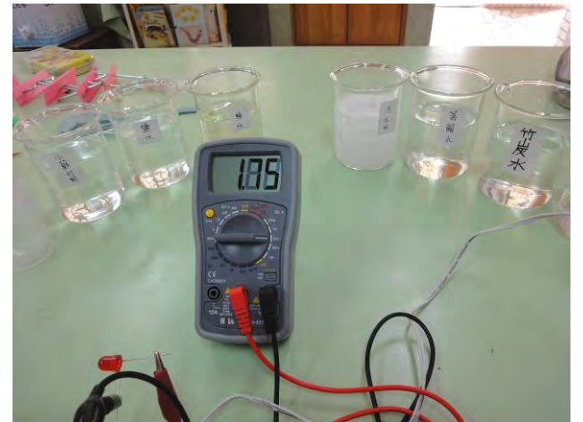
圖10 微亮的LED，代表水溶液中通過電流弱。
