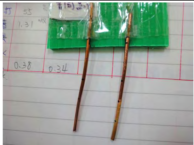
圖 19 受到附著物影響，銅線實驗時間越久，測得數值越低。
