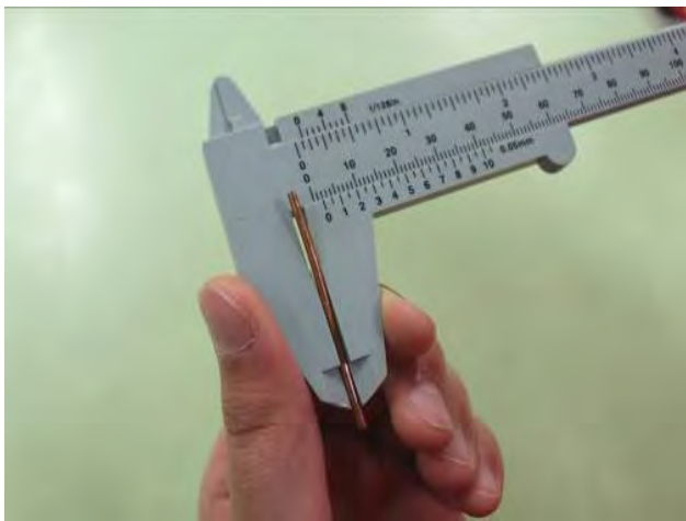
圖 15 利用游標卡尺測量直徑，以便計算表面積。
