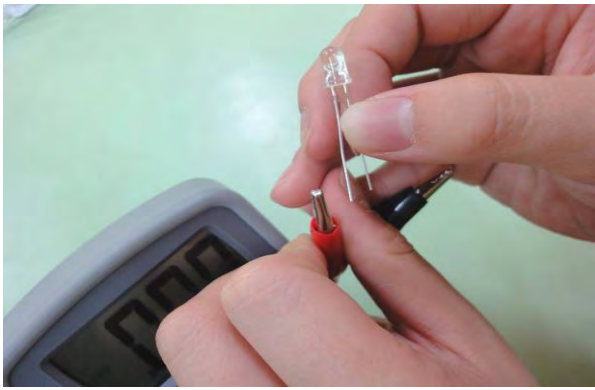
圖 35 LED 的接線兩端有長短、正負極之分。
