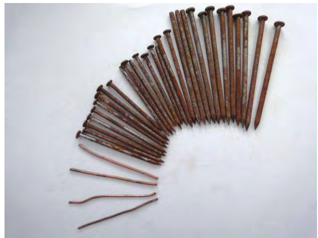
圖 18 鐵釘與銅線通電後容易與水發生作用。
