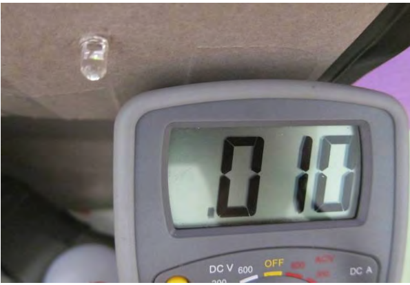
圖 36 仔細從斜上方看，蒸餾水亦使綠色高亮度 LED 發出微弱的光，但亮度不夠高，無法使照度計感應到光線，照度值為 0 lux。
