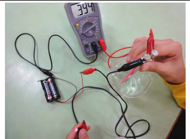
圖11 電池組電流隨時間越久，測得數值會下降。
