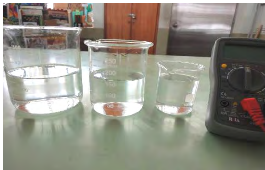
圖 43 不同容積燒杯，相同水溶液高度下，進行電流量測量。
