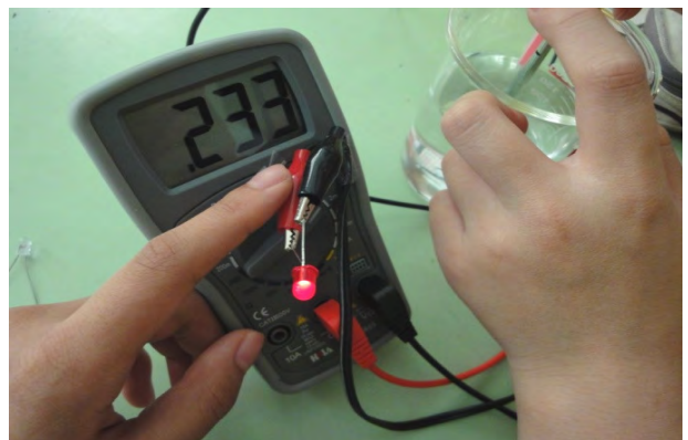
圖 40 電流量小時普通 LED，亮度不明顯。
