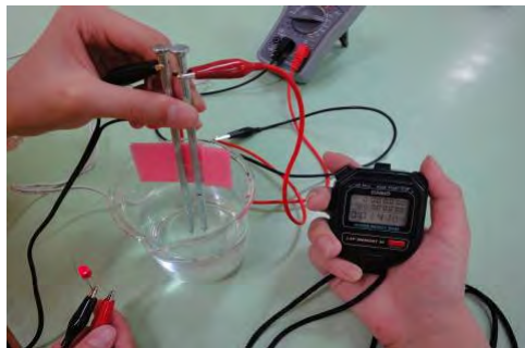
圖 20 電極棒在水中通電時間會影響測得電流值
