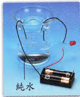
圖 53 使用我們所設計的導電檢測筆，可使純水發出微弱光亮，讓同學思考課本中「燈沒亮」的原因，作為延伸學習的教具。
