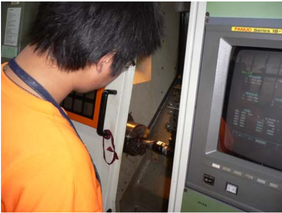
圖 24 CNC 車床加工踏板心軸
