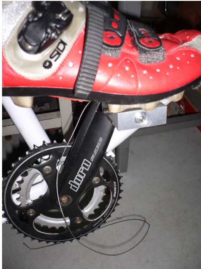
圖 32 卡踏使用卡鞋測試連接效果
