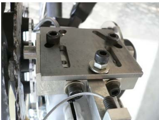
圖 28 煞車連動系統組立完成圖
