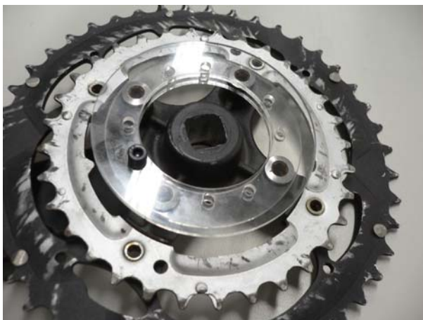
圖 15 右曲柄的圓盤固定方式設計
