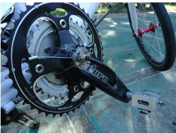
圖 40 完成的卡踏連接位置設計(右腳部分)
