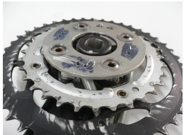
圖 27 圓盤及齒盤組立完成圖
