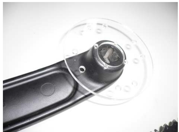
圖 16 左曲柄的圓盤固定方式(壓克力試做)
