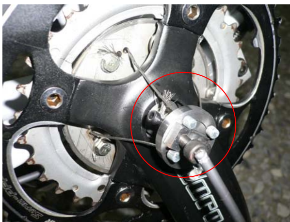
圖 36 圓盤有四條鋼索可以拉動
