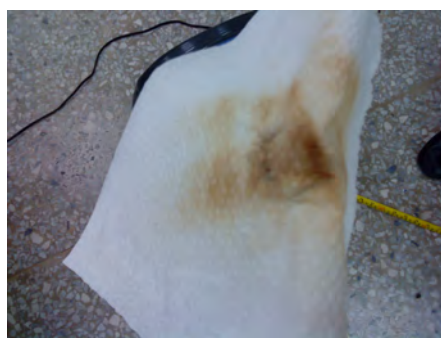
圖6-3 兩分鐘後可發現有焦黑的情形
