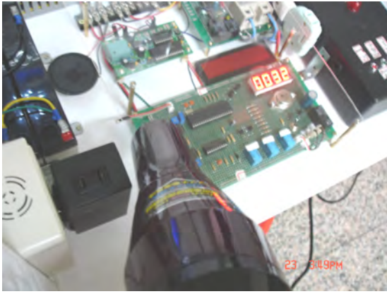
圖 4-50 模擬電暖器對感測器加熱
