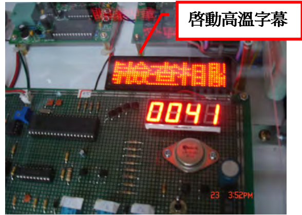
圖 4-51 偵測溫度達 40°C 以上啓動字幕顯示
