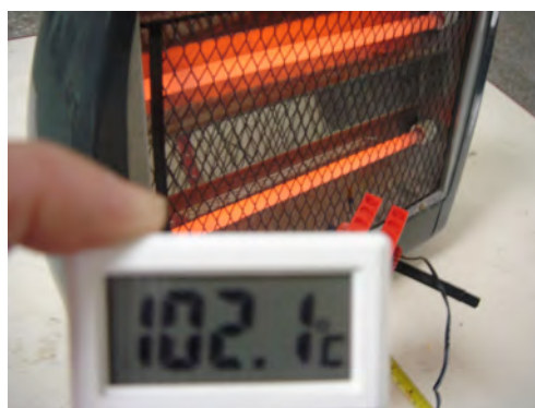
圖4-33 電暖器發熱溫度實驗照片
