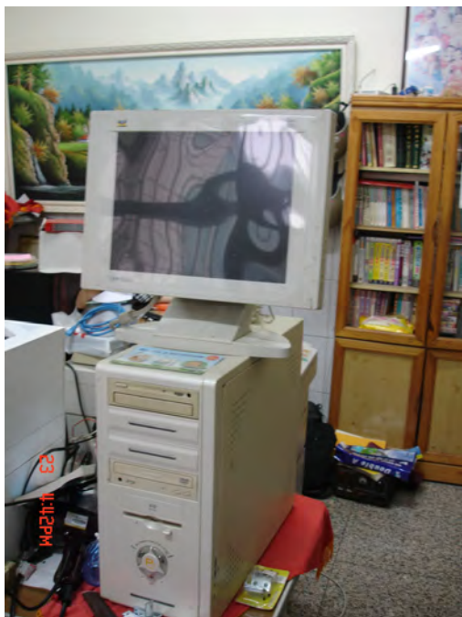
圖 4-46 電腦螢幕及主機待機消耗電功率 8.5W
