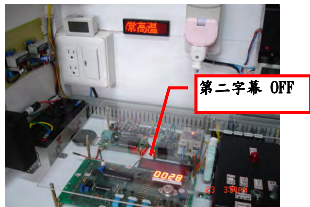
圖 4-53 低於下限溫度 30°C 保留上方字幕提示
