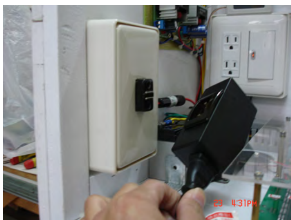
圖 4-17 絆到電線本轉接頭會自動脫落
