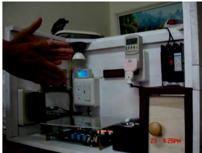
圖4-14 再拍兩下聲控插座令電燈熄滅
