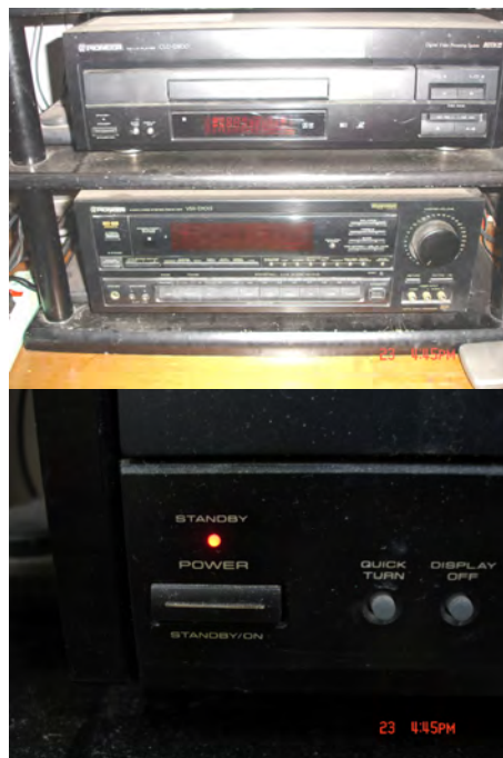
圖 4-47 音響主機待機消耗電功率 8.5W
