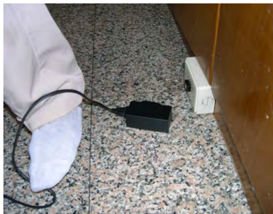
圖 4-16 絆到電線會自動脫落
