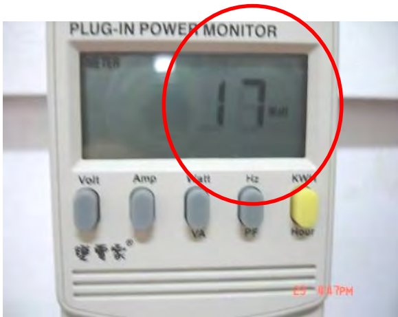
圖 4-24 出門前顯示電腦及音響待機耗電(W)
