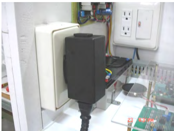
圖 4-15 電器插上磁性插座
