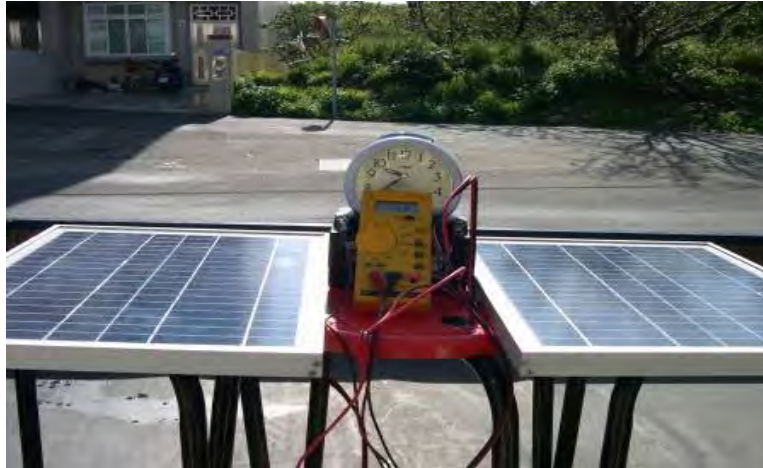
圖4-29 太陽能供電實測可達1.5A
