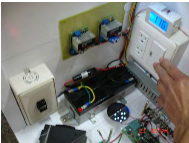
圖 4-27 手動切開插座有電
