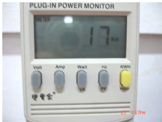
圖 4-45 電腦及音響主機合計待機耗電 17W
