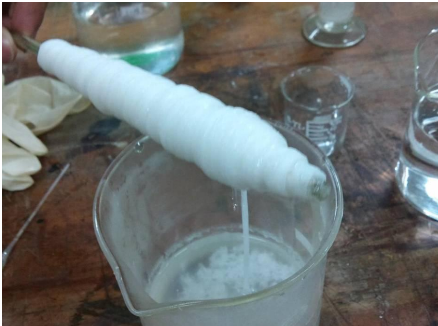
圖1-1 溶液界面處形成耐綸，抽出耐綸
