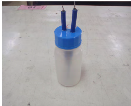
圖9. 偵測介電係數感測器結合取樣罐瓶蓋
