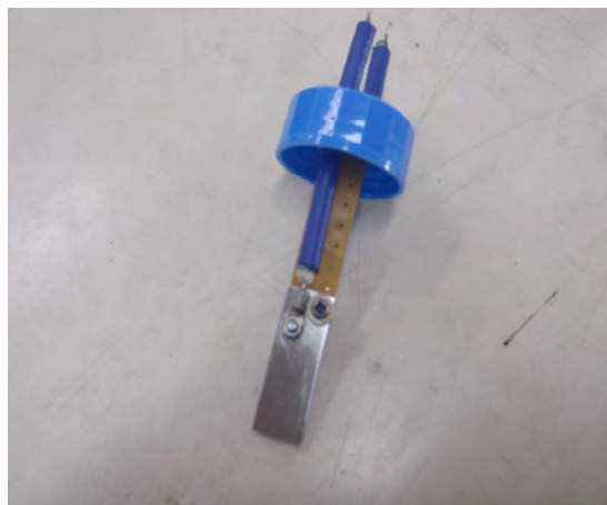
圖8. 偵測介電係數感測器實體照片
