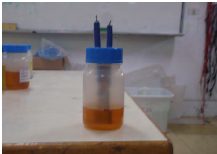
圖10. 取樣罐瓶食用油的偵測位置設計照片
