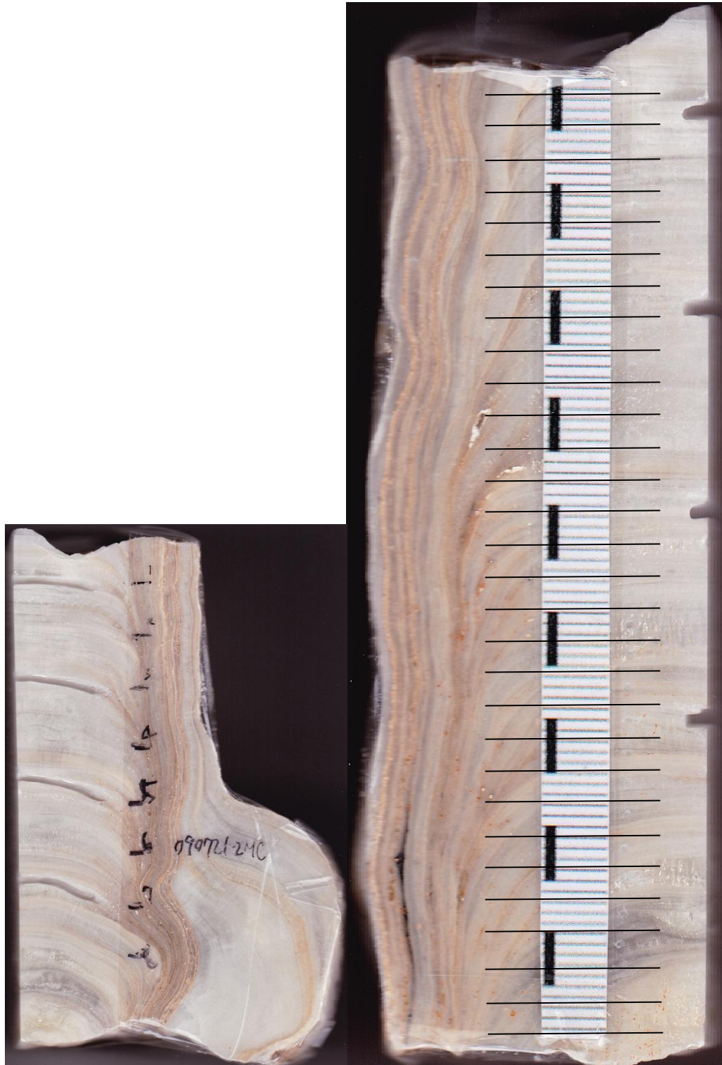
圖(十四) 石筍樣本比例尺及鑽孔位置：黑線所指的位置為鑽孔位置，水平橫線間距為 3mm。(右邊為實驗材料)
