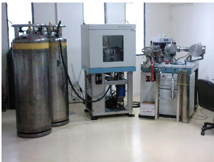
圖(一) 進行碳氧同位素和 Hedy Test 的儀器：Thermo-Finnigan MAT252-IRMS。
