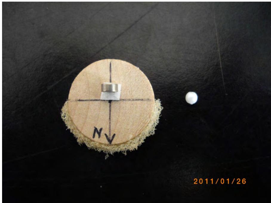
圖(廿三)海綿表面的粗糙特性可能增加了塑膠小珠與模型碰撞時切線方向的作用力，從而使貼有海綿的這半圓周上會有較大的平均衝力，我們在實驗過程中總是看到模型A4會向沒有黏貼海綿的那個方向移動過去。
