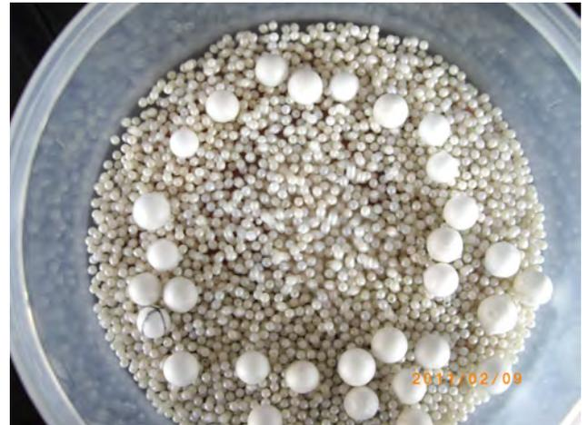
圖（廿一）在某些振動頻率時，塑膠盆會形成特定的駐波模式，導致盆類的各種模型都會向駐波波節處集中，這種情況會影響我們對模型運動特性分析的正確性。
