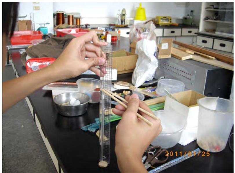
圖（廿二）把透明吸管黏在直尺上，讓塑膠小珠由距底部20cm處自由下落，由其反跳高度就可以很簡單的算出碰撞時的恢復係數了，實驗中塑膠小珠碰到木質模型的平均反跳高度為6.4cm，塑膠小珠碰到海綿的平均反跳高度為為6.0cm，換算成恢復係數的定義則分別為0.57和0.55，其差異並沒有原先想像中那麼大。
