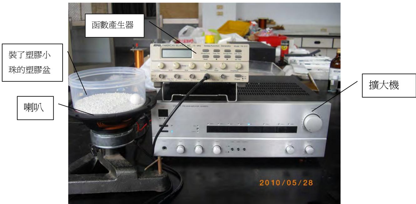
圖（一）函數產生器、擴大機、喇叭組合起來的振動裝置。
