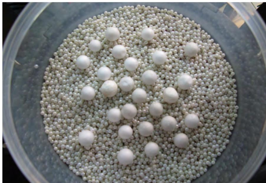
圖（二）置於塑膠盆內的塑膠小珠（用來模擬分子）和保麗龍球（用來模擬懸浮微粒）；喇叭開始振動後，模擬分子就會對模擬微粒不停的進行隨機碰撞，而模擬微粒的行為會類似於布朗運動。
